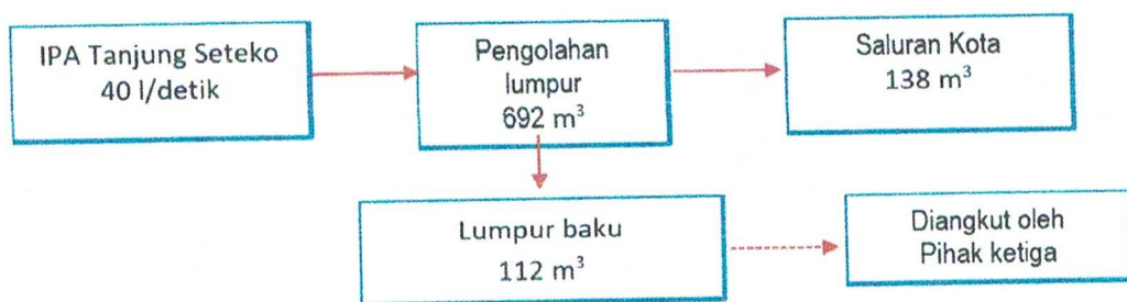
Gambar 8. Alur Proses Pengolahan Lumpur IPA Tanjung Seteko
